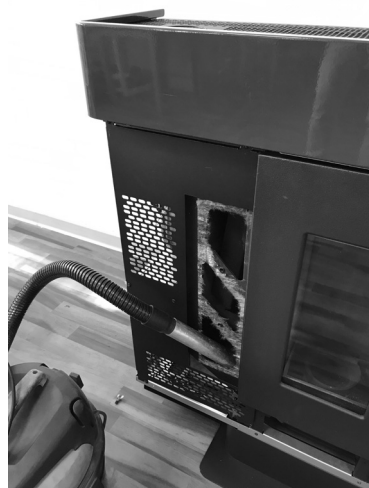
Fig. 37 - Czyszczenie komory spalin
