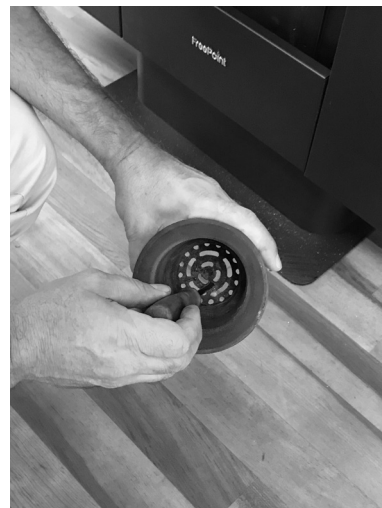
Fig. 29 - Czyszczenie rusztu paleniskowego
