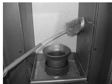
Fig. 32 - Czyszczenie szczotką
